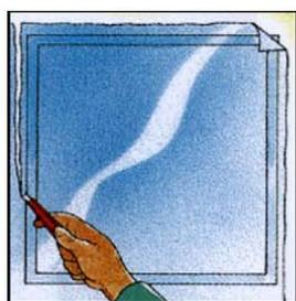
2 - Prédécouper le film avec le cutter à un format supérieur de 2 à 3 cm à celui du vitrage
